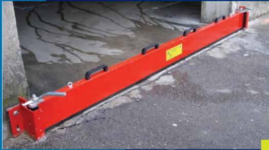
La mise en place de la barrière est simple et rapide. Il suffit de la positionner dans les deux glissières et d'effectuer un quart de tour avec les broches afin de mettre les joints en pression. L'étanchéité est donc réalisée.
